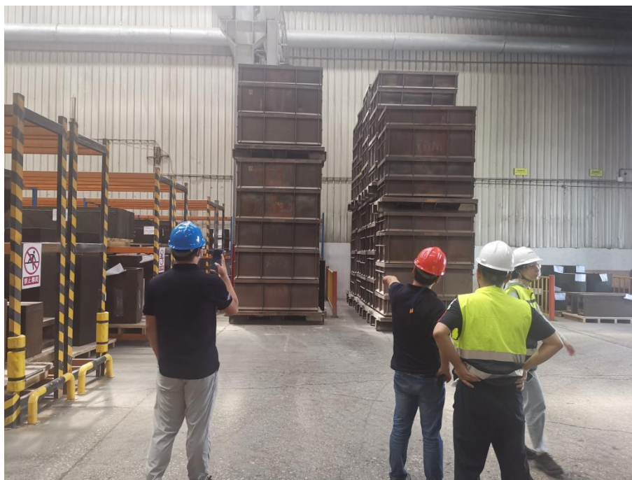
图 15 堆垛超出了划定的物品暂存区域
