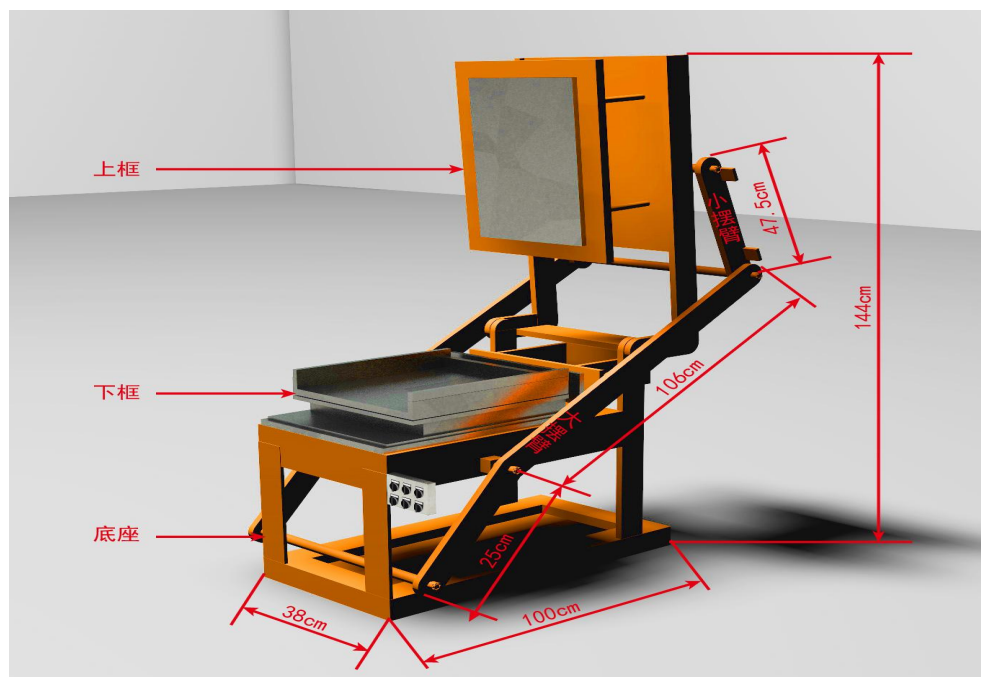
图 3 发泡机结构示意图
