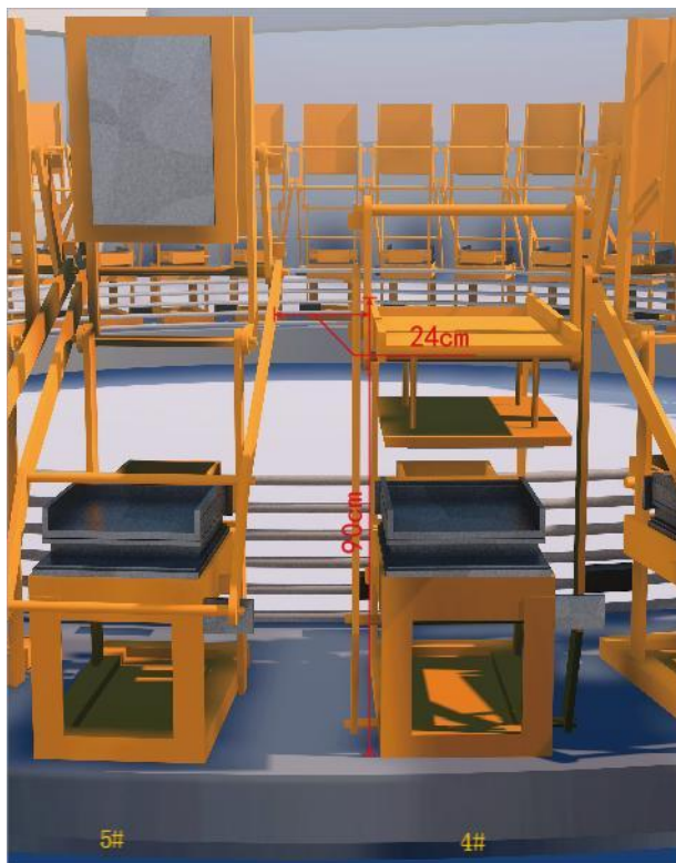
图 7 4 号发泡机合模示意图
