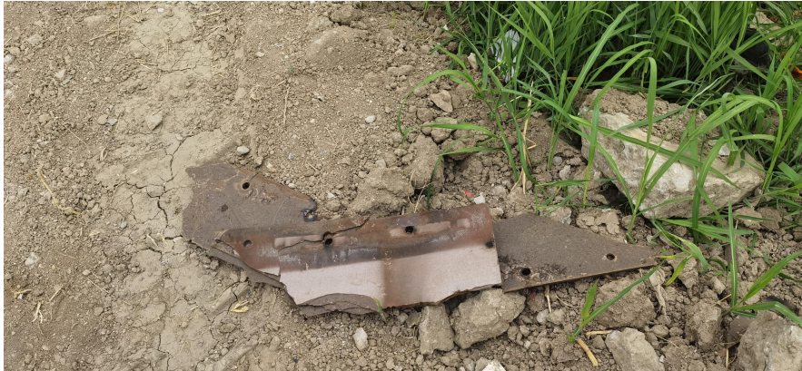
图三 原已损坏的绝缘板
