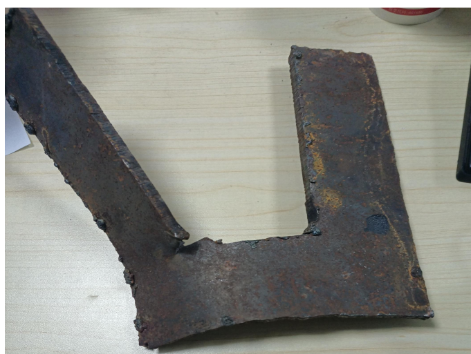
图四：事故发生后“变形”铁卡子
