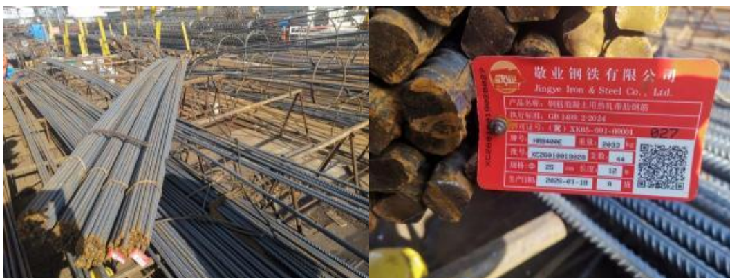
图5 事发时吊运的4捆钢筋及其铭牌
