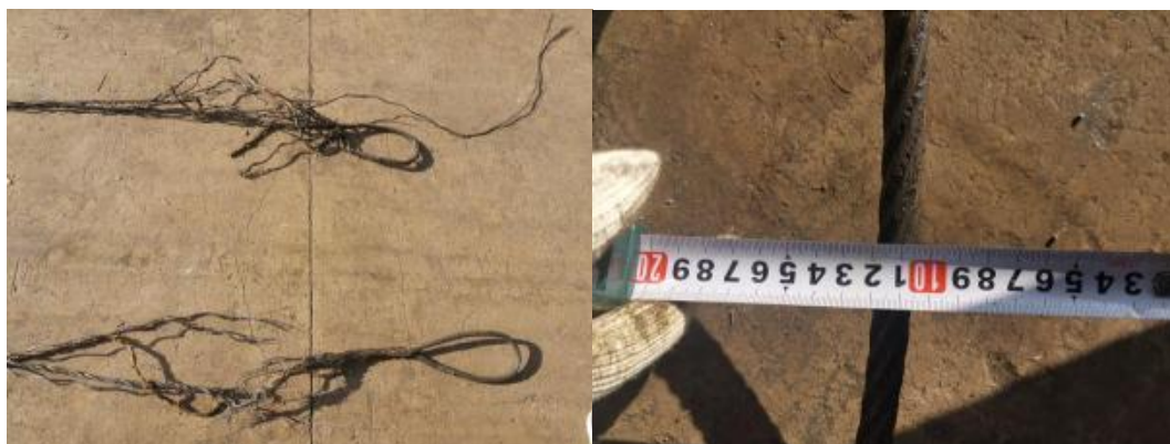
图 7 索具钢丝绳长度与直径测量
