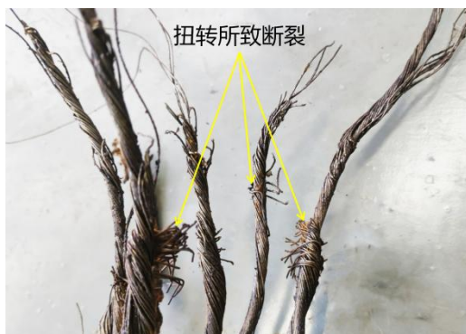
图 8 索具钢丝绳断裂形貌
