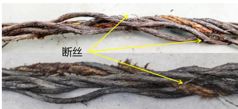
图 9 索具钢丝绳断丝形貌
