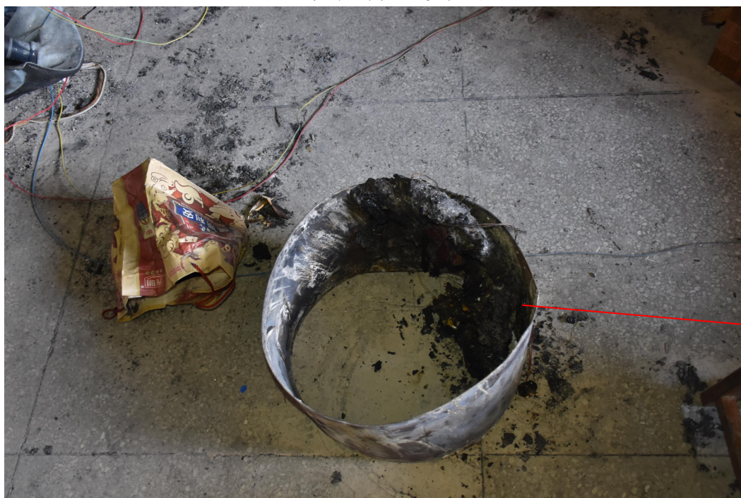
图10 烧损的洗衣机内筒
