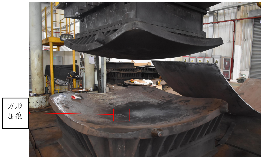
图7 液压机作业平台
