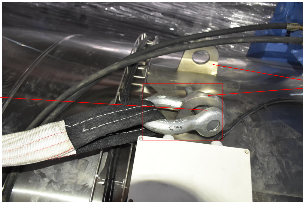
图14 涉事杀菌釜北侧一对吊耳装置
