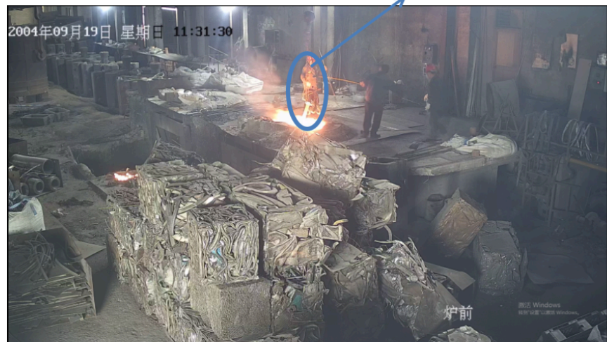
图2 中柱料掉入炉内
