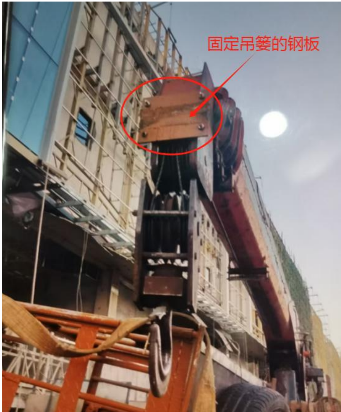
图 2 涉事随车吊臂前端
