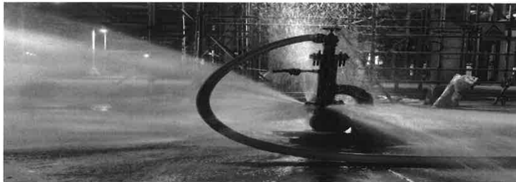
图 4 对脱丁烷塔底密排法兰泄漏情况模拟实验
