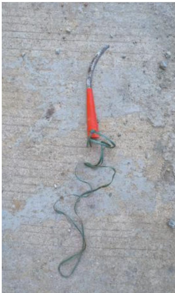
▲图 4：拆除竹木棚架使用的工具
