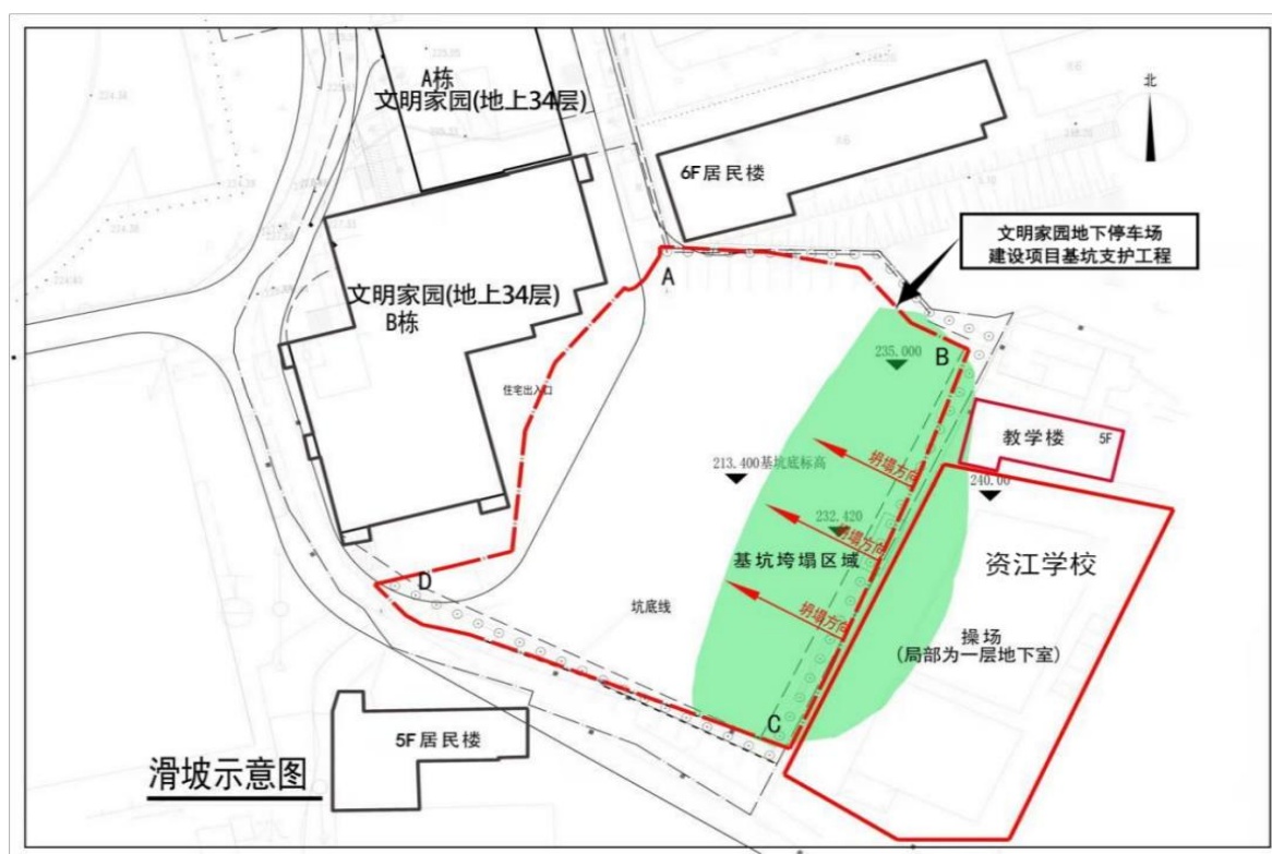
图 1 现场基坑及地面坍塌示意图
