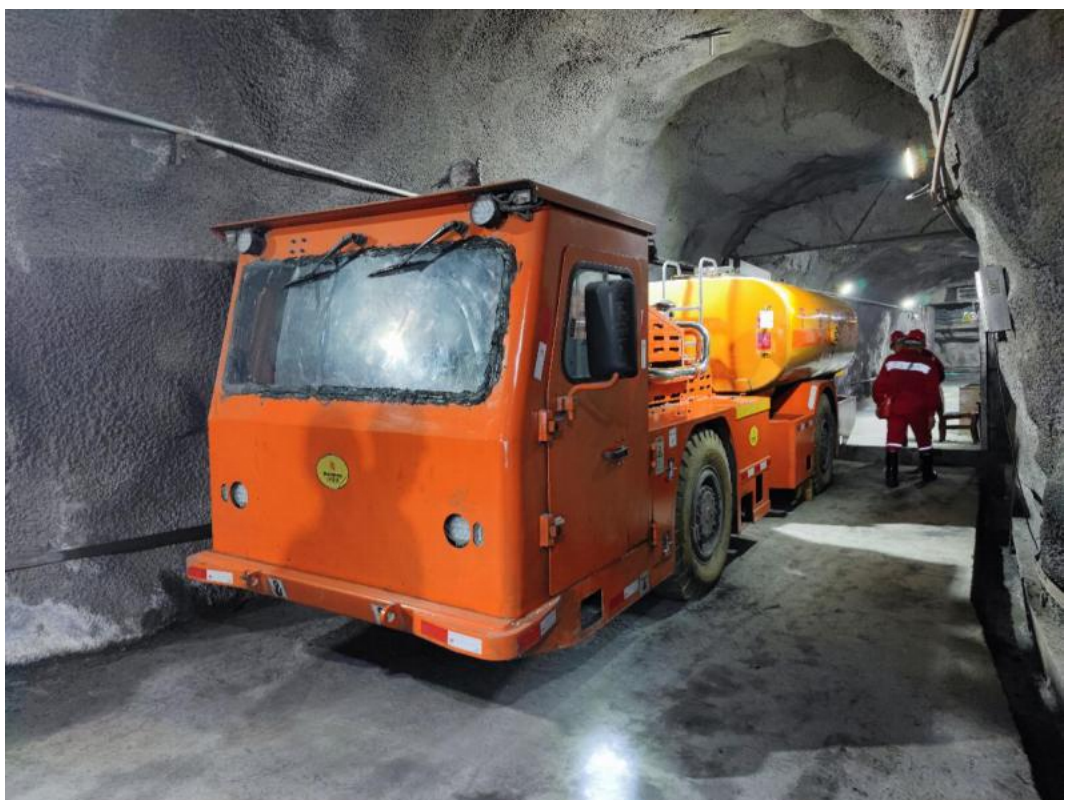
图 3 重新集铁矿-500m 中段井下油罐车
