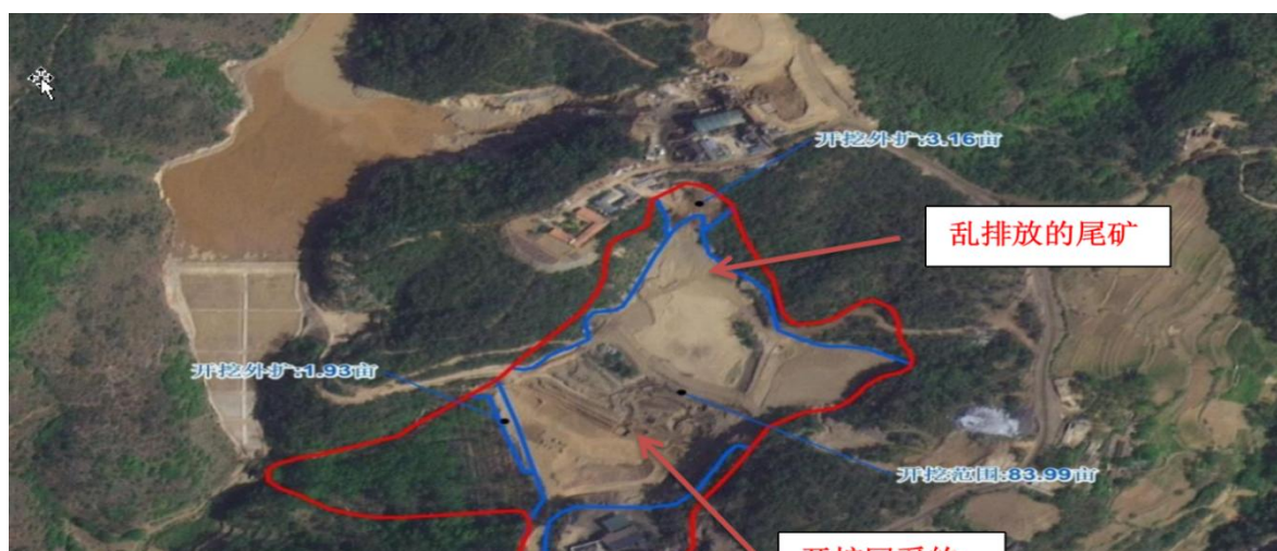
图4-3 2023年键丰公司开挖回采1号尾矿库及向1号尾矿库库尾上游乱排放尾矿的卫星照片
