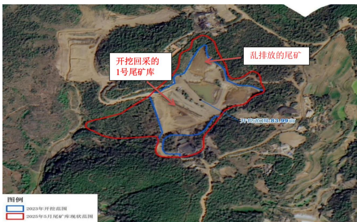
图4-3 2023年键丰公司开挖回采1号尾矿库及向1号尾矿库库尾上游乱排放尾矿的卫星照片
