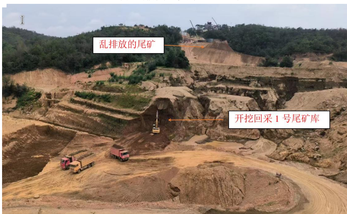
图4-5 2024年键丰公司回采1号尾矿及向1号尾矿库库尾上游乱排放尾矿的现场照片
