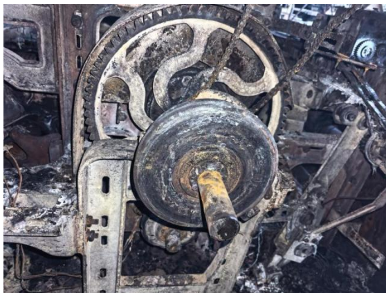
图 3 301 织布机离合器拆解情况
