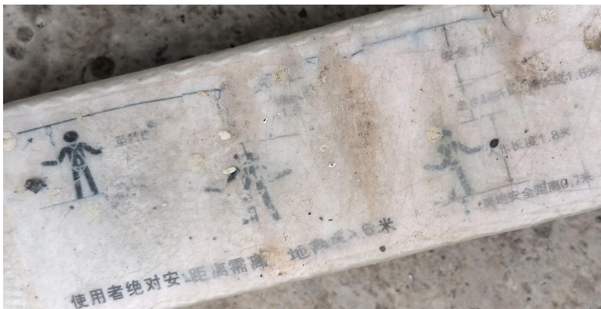
图 5 缓冲式安全绳（上面显示：距离需离地高度 \geq 6 米）
