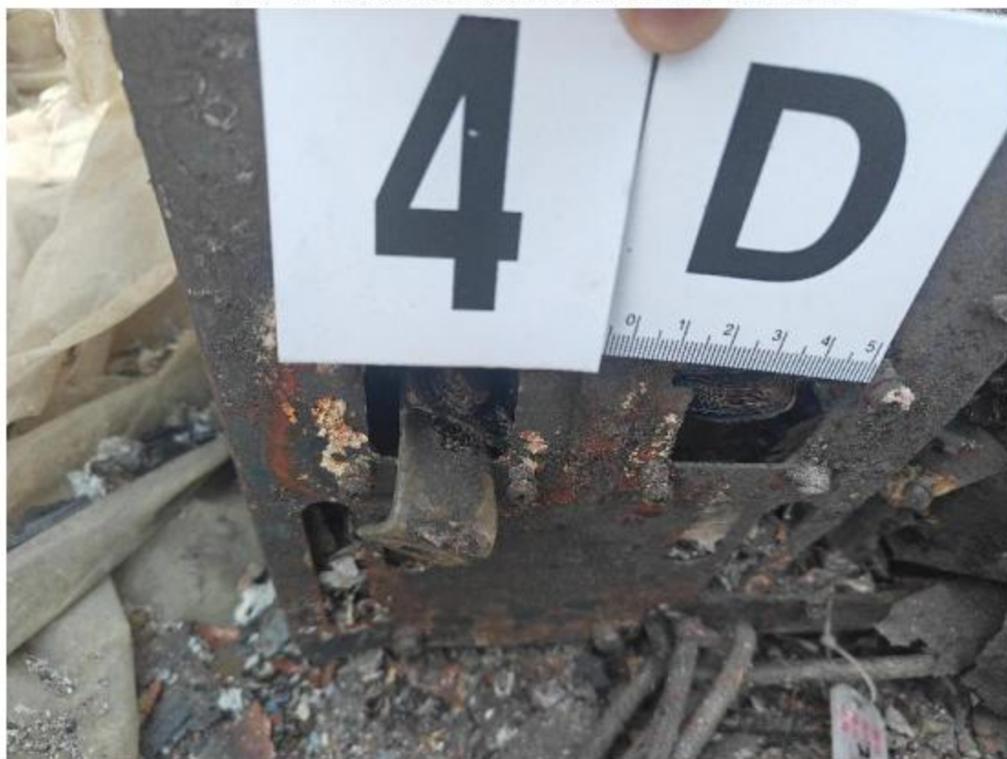
图五：于2堆1簇20#电池包正极提取输出铜排1个
