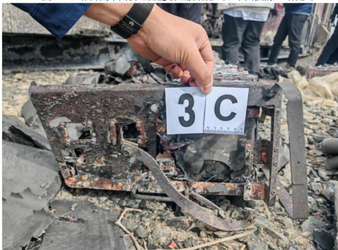
图三：于 2 堆 1 簇 7#电池包负极提取螺栓及输出铜排 1 个
