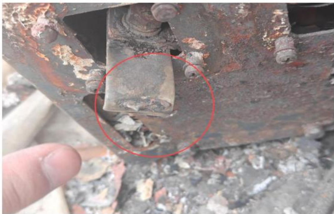
图六：输出铜排上可见尖状熔痕
