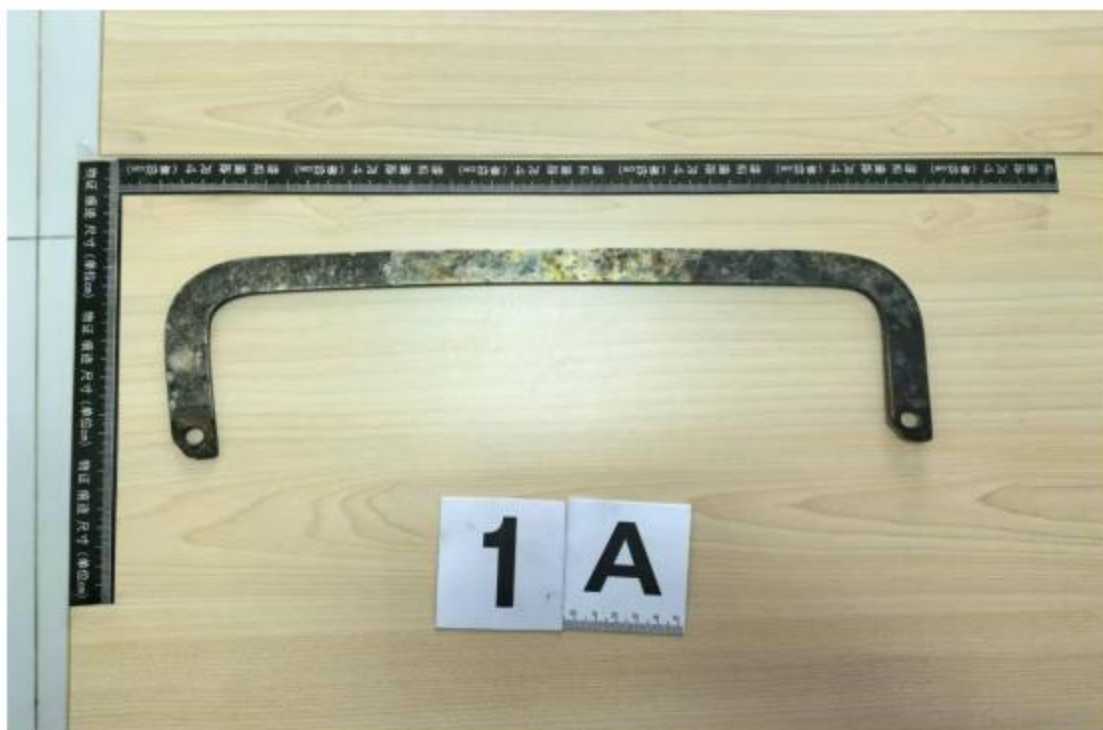
图二：工作升高车南侧地面提取连接铜排1个，两端熔融，有熔珠
