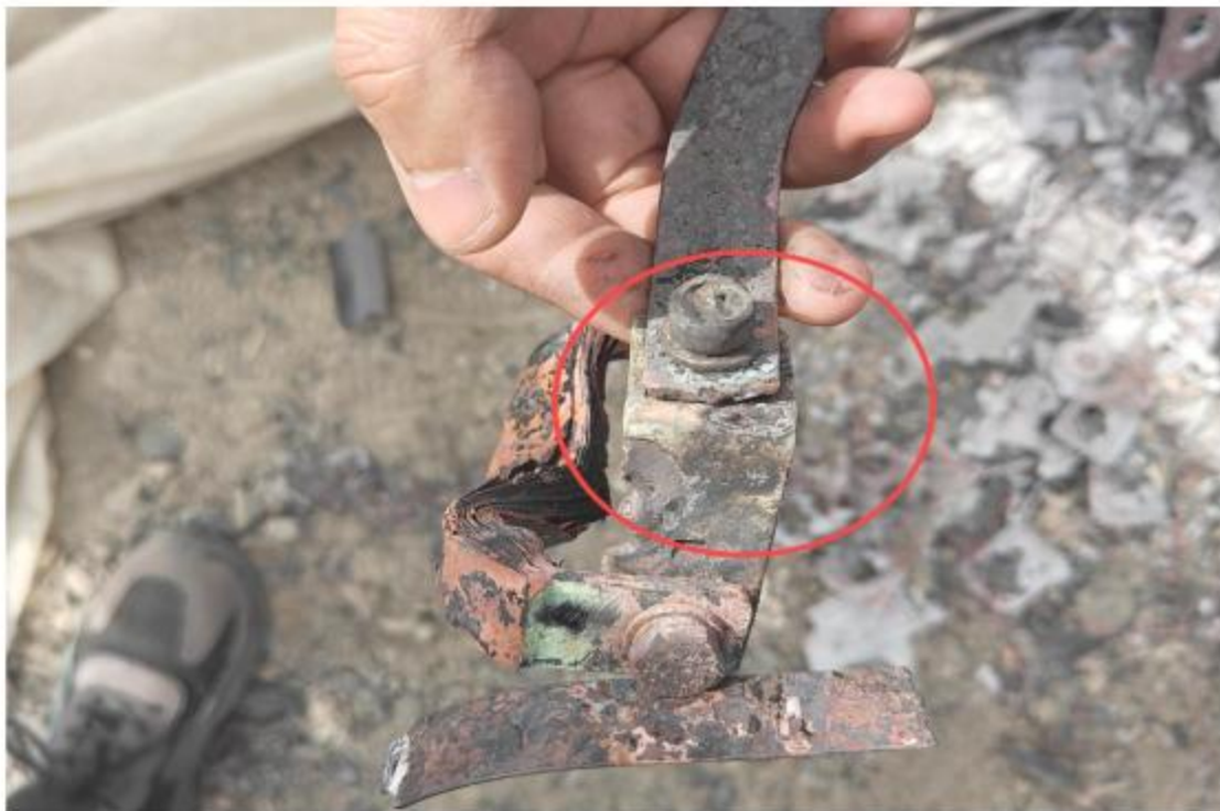
图四：7#电池包负极输出铜排上可见凹坑状熔痕
