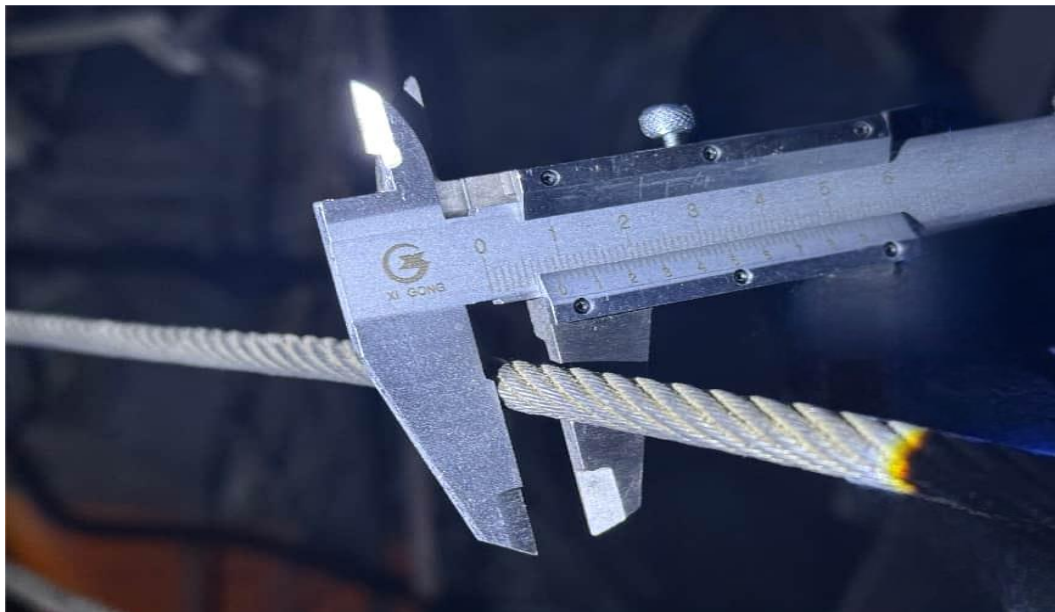
图 12：事故现场所用钢丝绳直径测量
