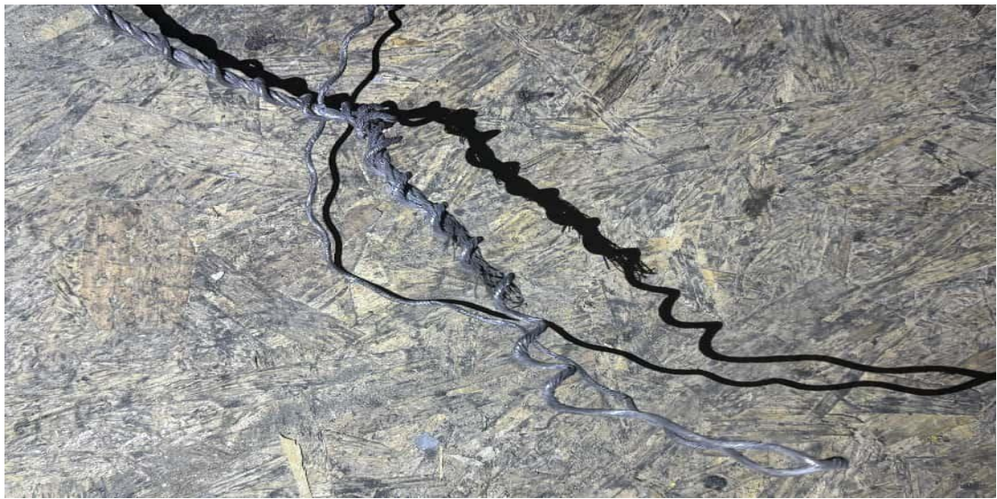
图 11：事故现场钢丝绳断头处照片
