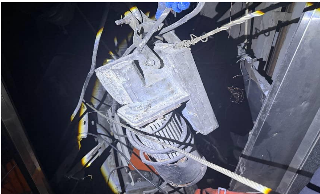
图 9：发生坠落事故后的单股钢丝绳“提拉克”
