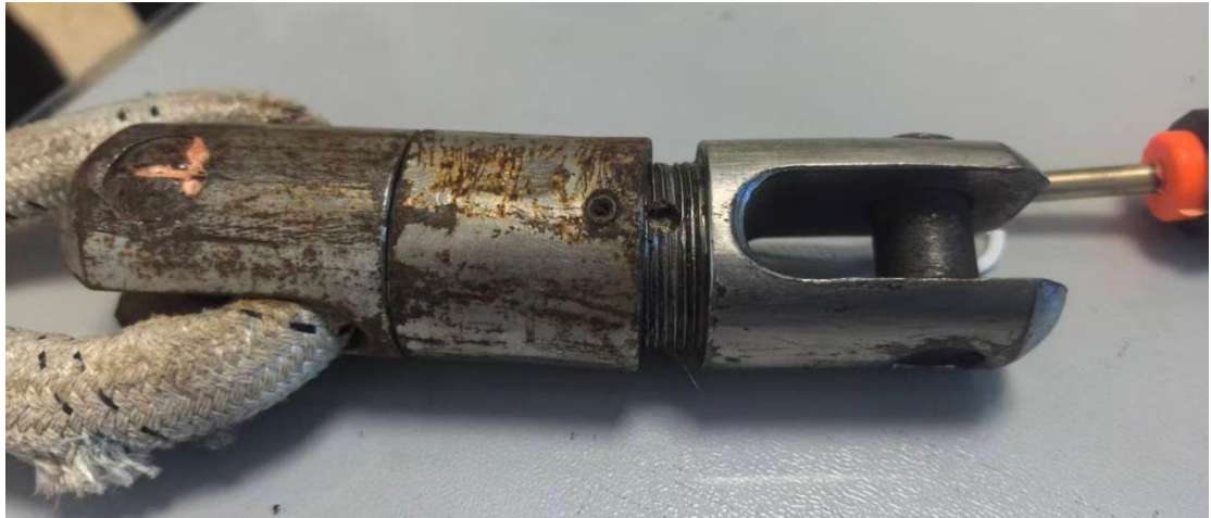
图 17 定子端螺纹受损情况及端头毛刺
