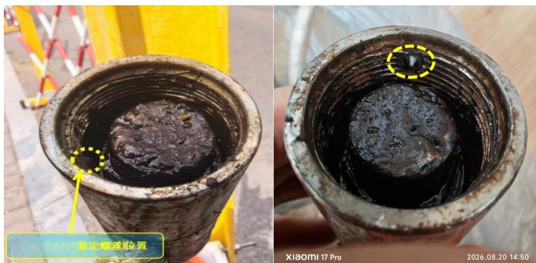
图 12、13 中间旋转机构螺纹及紧定螺丝锥形端头状态
