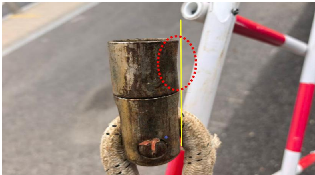
图 11 旋转连接器受损后呈现向内凹陷状
