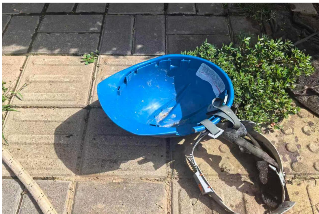
图 22：事故现场安全帽无“三证一标志”
