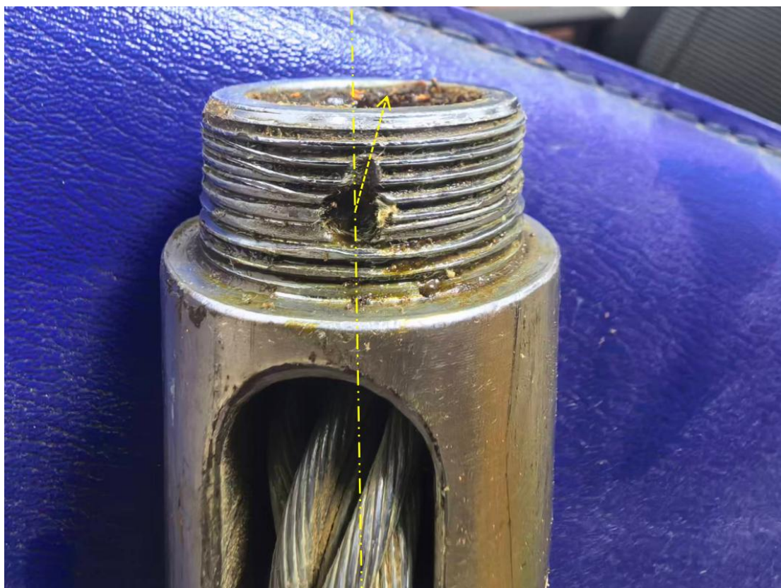
图 15 旋转连接器定子螺纹端头受损情况
