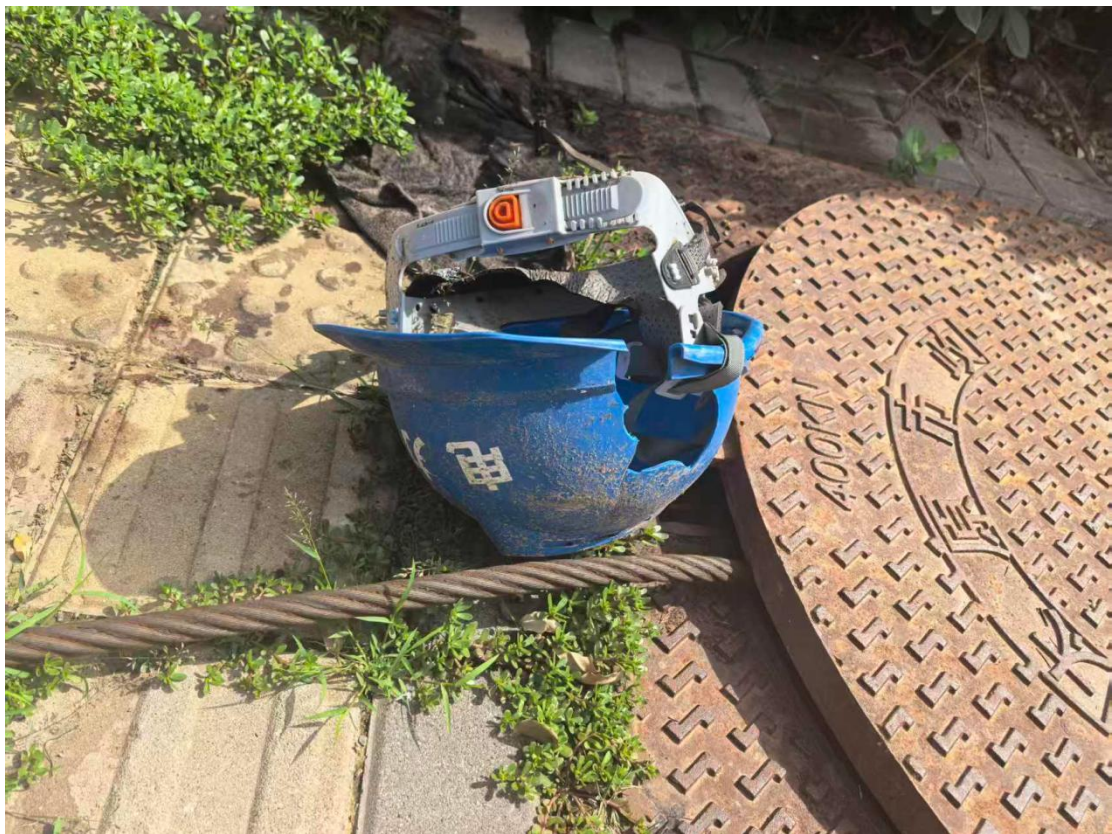
图 23：事故现场安全帽帽壳发生碎片脱落
