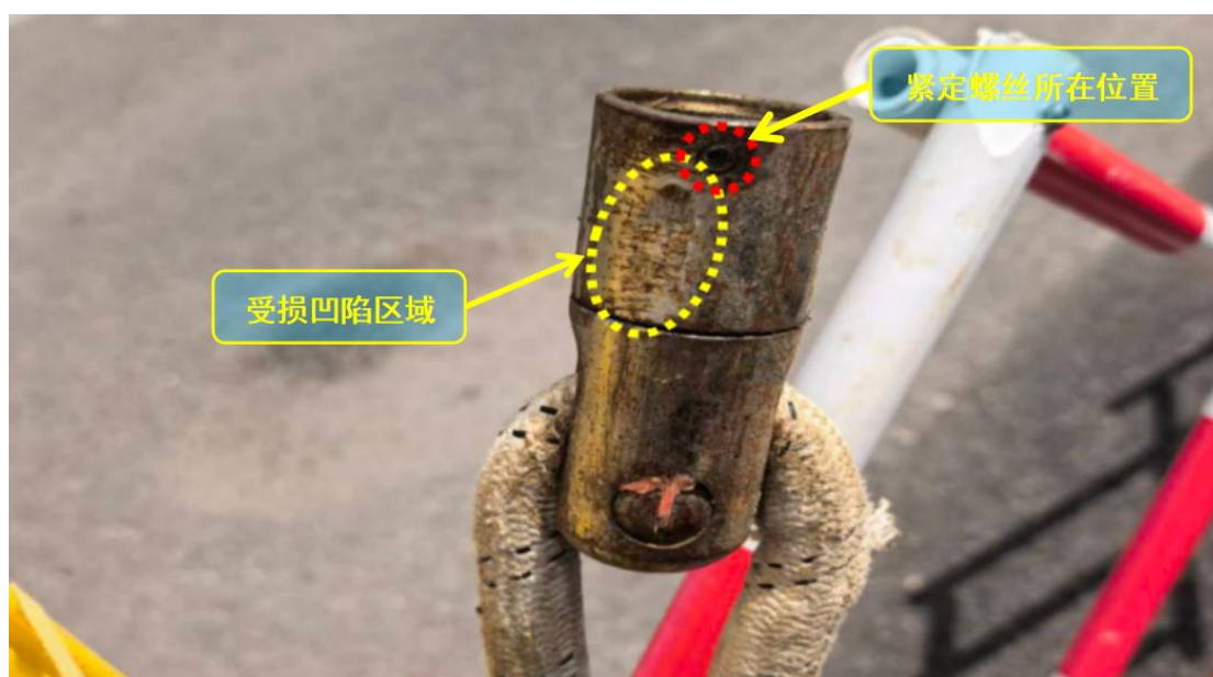
图 10 旋转连接器受力变形位置与紧定螺丝位置
