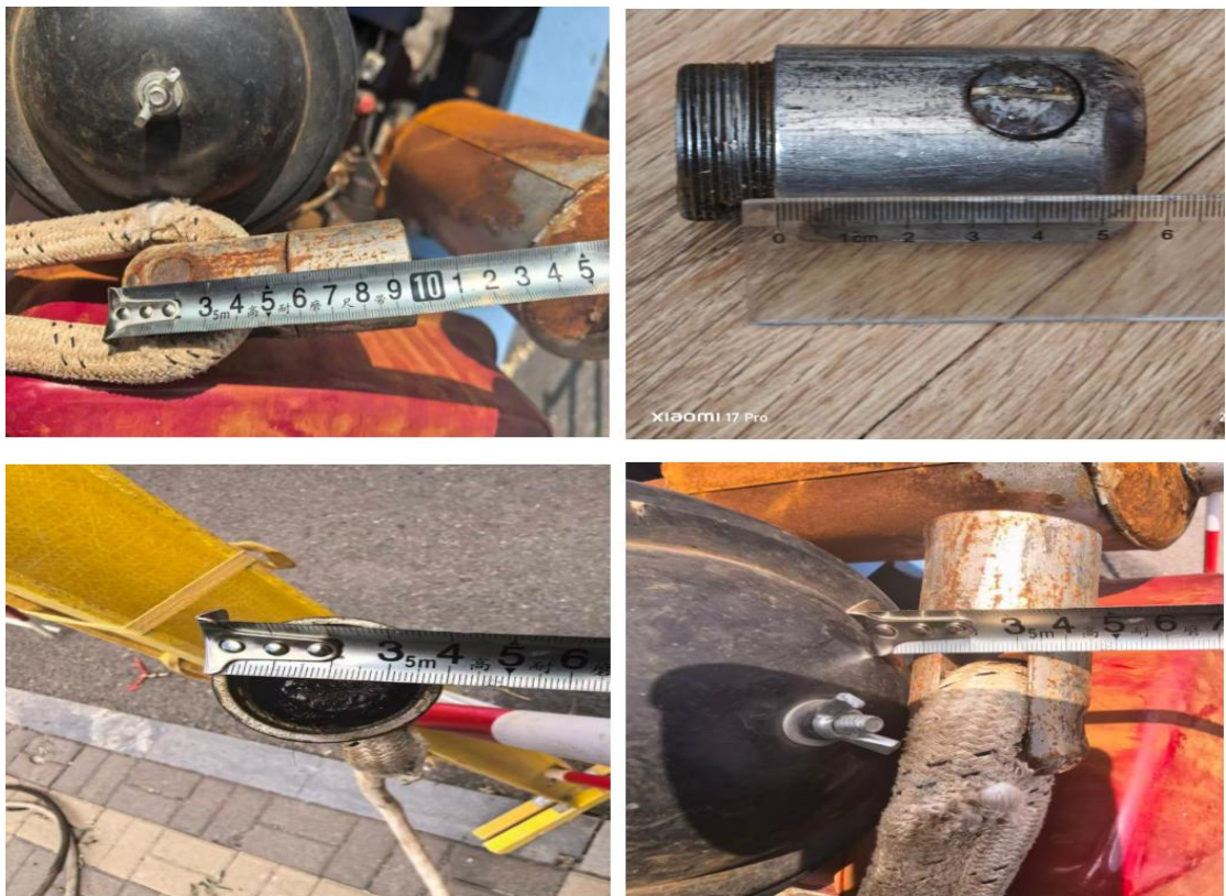
图 18 涉事旋转连接器各部尺寸
