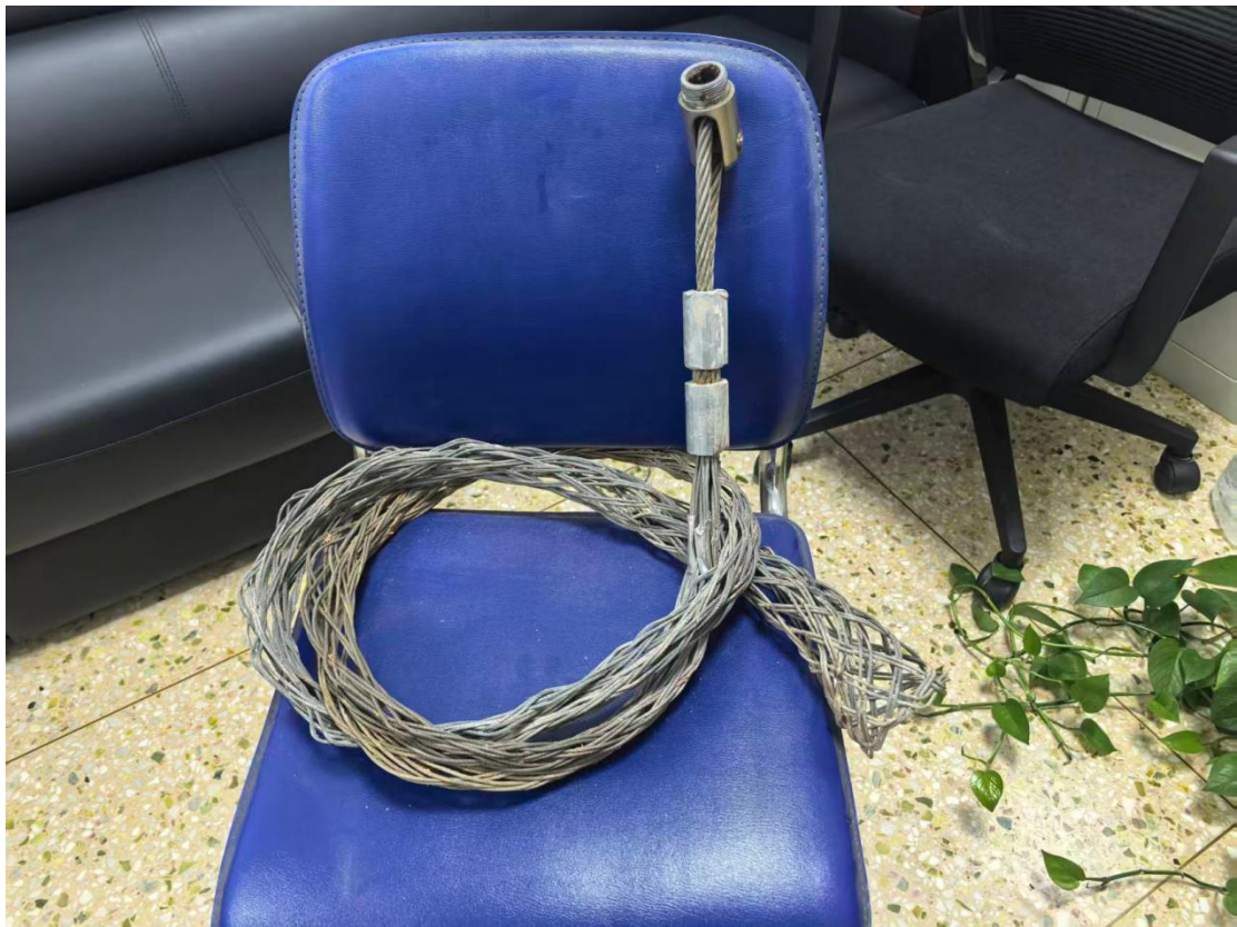
图 14 旋转连接器定子端与电缆牵引钢丝网套连接状态
