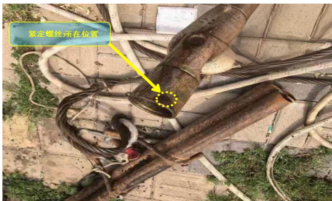
图 9 事故现场的不完整的旋转连接器
