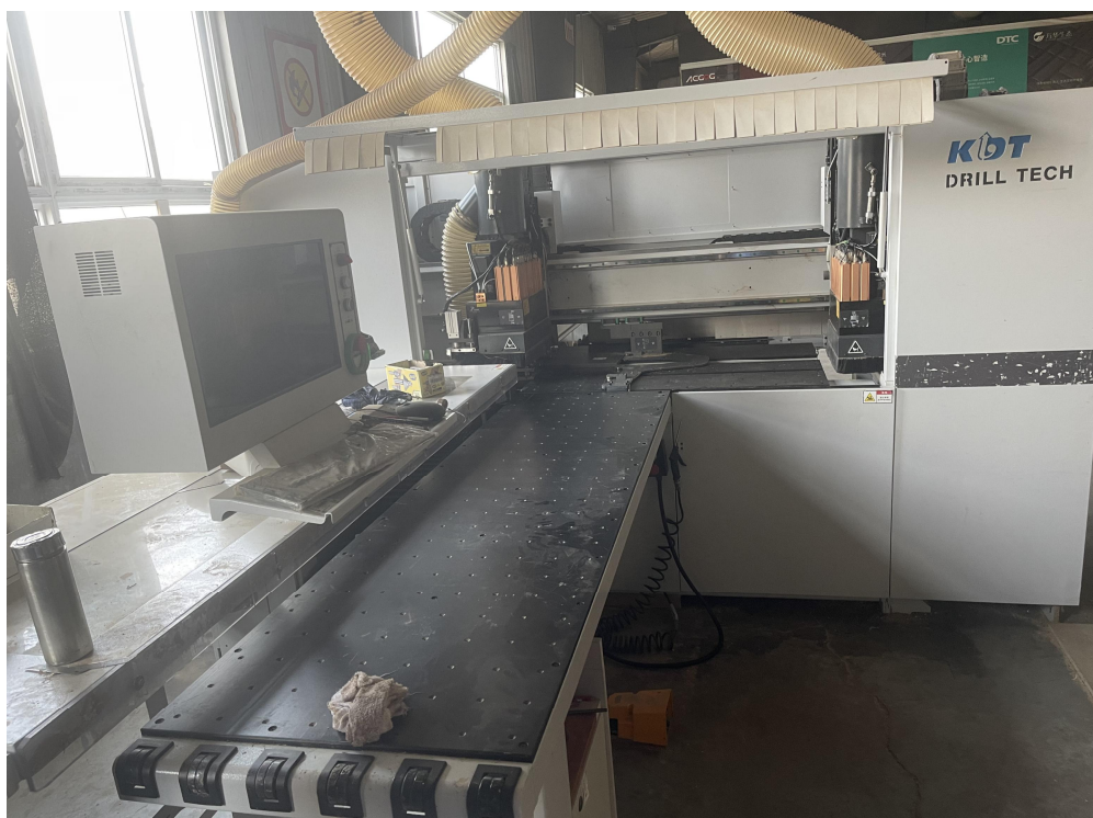
图 1：发生事故的数控钻孔中心
